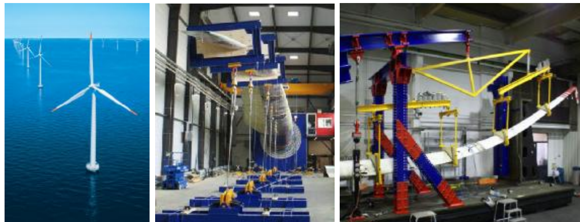
Weltweit einzigartiger Prüfstand für Rotorblätter von Windkraftanlagen am Fraunhofer IWES in Bremerhaven
